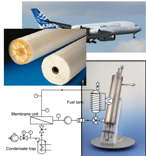
Unser Konzept sieht vor, dass je nach Schwefelgehalt des Kraftstoffs verschiedene Verfahren zur Entschwefelung eingesetzt werden. Membranverfahren scheinen insbesondere für die Grobentschwefelung erfolgversprechend.
